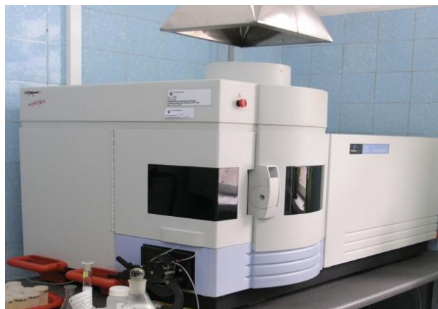
Rys. 11. Spektrometr emisyjny z plazmą wzbudzoną indukcyjnie OPTIMA 2000DV firmy PRERKIN-ELMER
